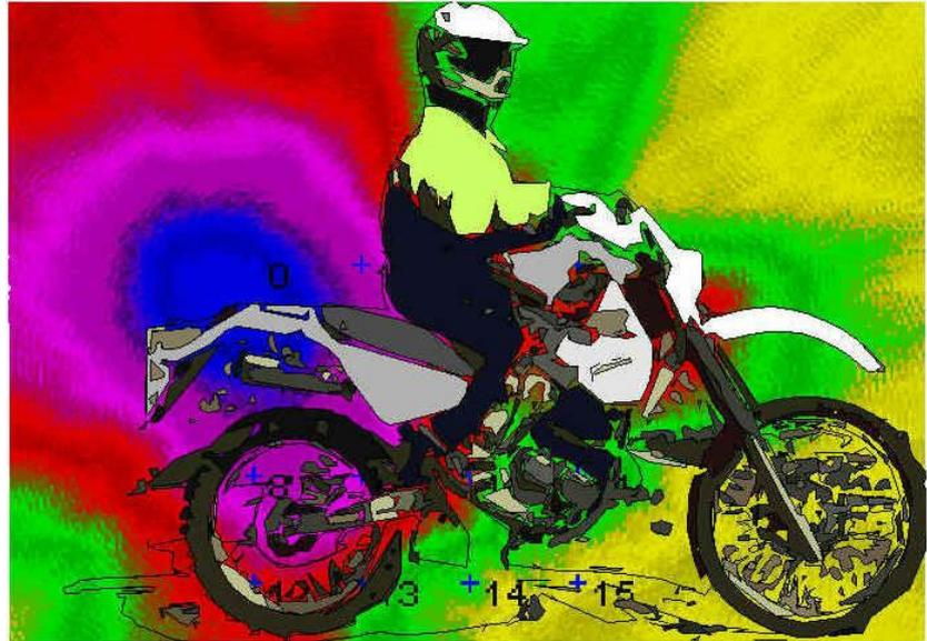
**Lärmbild eines fahrenden Motorrads: Je kälter der Farbton, desto leiser das Geräusch. Rot zeigt die extremste Lärmquelle an.**
