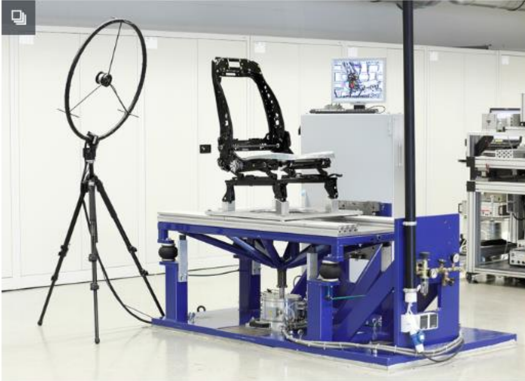
Eine Akustik-Kamera macht Geräusche an Sitzstrukturen punktgenau sichtbar. Foto: Auto-Medienportal.Nef/Johnson Controls
