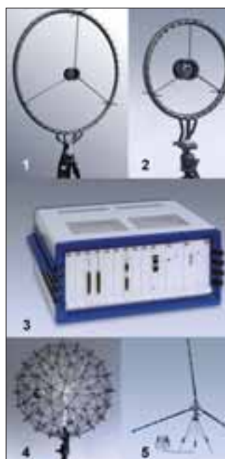
Bild 1: Hardware-Komponenten (Arrays und Datenrekorder) der Akustischen Kamera (Bilder: GFaI)
