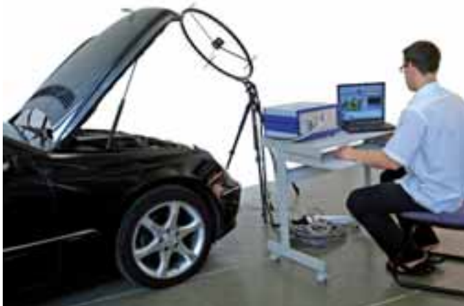
Bild 1: Typische Szene für eine Messung mit der Akustischen Kamera unter Verwendung eines ringförmigen Mikrofonarrays
