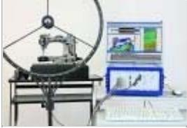
Durch die exakte Überlagerung mit einem normalen Videobild gelingt eine anschauliche und schnelle Darstellung von Geräuschen. Haupteinsatzgebiete sind die Bereiche Lärmreduzierung, Sounddesign, Qualitätssicherung.
