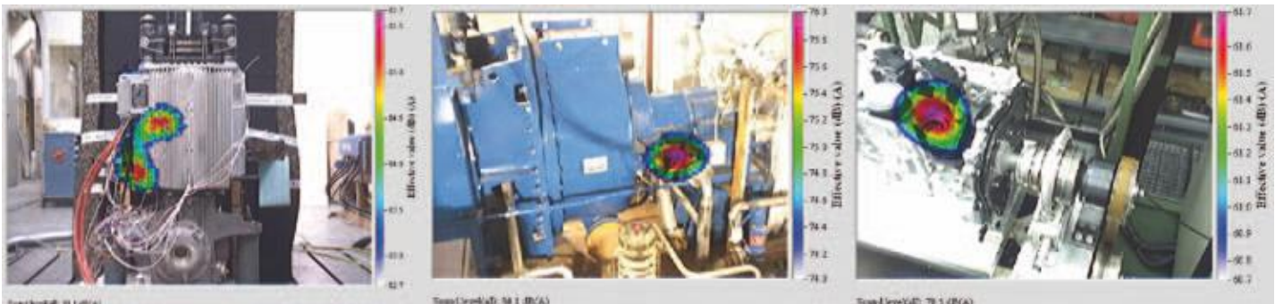
Detektion von Lärmquellen mit der akustischen Kamera an einem Elektromotor, einem Gasturbinengetriebe und bei einer Getriebe-Prüfstands-messung
