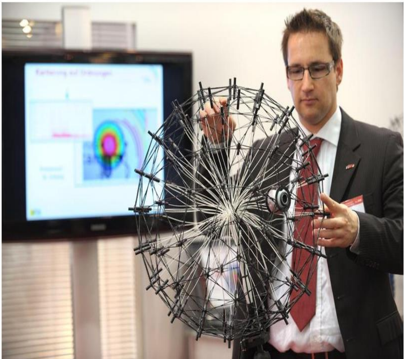
Ingenieur Kevin Farr zeigt eine sogenannte „Acoustic Camera“ der Firma gfaï tech. Die Kamera dient zum Lokalisieren akustischer Emissionen.
