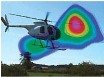
Lärm beim Helikopter: Den höchsten Wert misst die Spezialkamera an der Rotorspitze.
