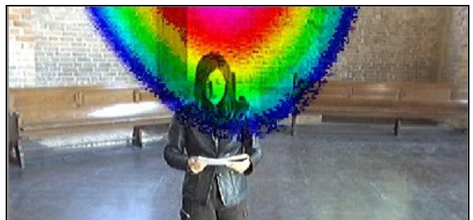
Abbildung 5: Abhebbende Stimme im Wellenfeld bei 24.000 Bilder/sec (42µs); Zeitachse von li. nach re.. Unten: Integral über diesen Bereich von insgesamt 70 Frames (3 ms) [N03]
