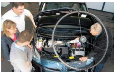
Ein Kranz mit 48 Mikrofonen hilft, Lärmquellen im Motorraum exakt zu lokalisieren. Die sogenannte Akustische Kamera – hier ohne Videokamera in der Mitte – wurde am „Tag gegen Lärm“ beim TU-Fachgebiet Systemzuverlässigkeit und Maschinenakustik vorgeführt. Foto: Claus Völker
