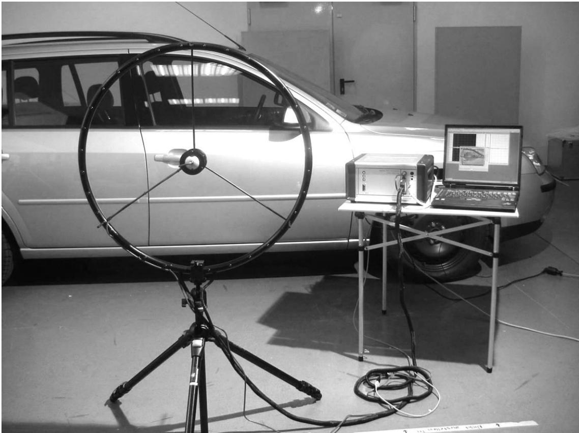
*Bild 4: Akustische Kamera bestehend aus Array, Rekorder und Auswerterechner*
