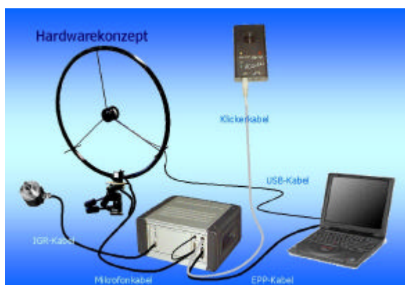
Abb.6 Gesamtsystem "Akustische Kamera" mit Ring32-Array
