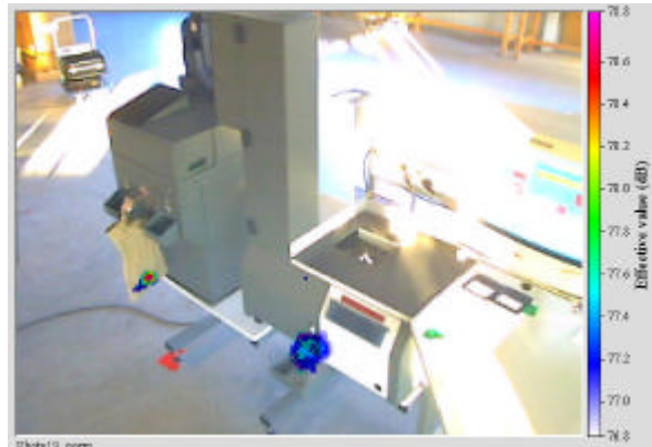
Abb.4 Filmausschnitt einer Geldsortiermaschine (C-Bewertung, Portable). Zu erkennen ist eine Emission von Münzen, die in den Geldbeutel fallen, sowie eine Emission am vorderen Aussortierkasten
