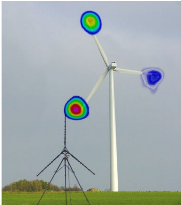
Abb.5 Windkraftanlage ebenerdig aus etwa 100 Metern Entfernung aufgenommen. Wir stehen im Wind hinter der Anlage. Der jeweils abwärts laufende Flügel „leuchtet“ an der Spitze stärker (A-Bewertung, max. 34 dB)
