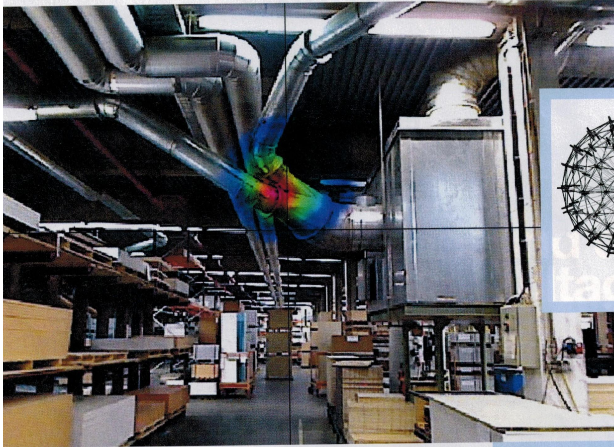
Den Lärm sehen. Das Mikrofon-Array hat eine Verzweigung der Lüftungsrohre als Lärmquelle enttarnt.
