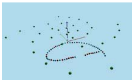
Ergebnis nach der Berechnung: die Positionen der Mikrofone sind grün gekennzeichnet
