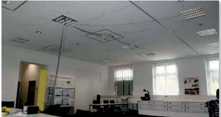
Spiralarray an Decke: 48 Mikrofone; Durchmesser ca. 6 m
