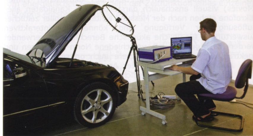
Abbildung 117: Messung mit der Akustischen Kamera
