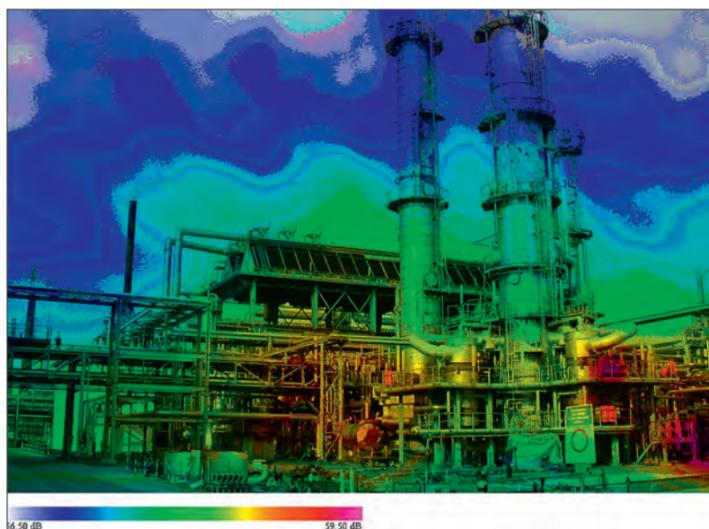
Durch die Überlagerung des akustischen Bildes mit einem Realbild ist es einfach, die entsprechenden Stellen zu lokalisieren. Bild: Gfai Tech
