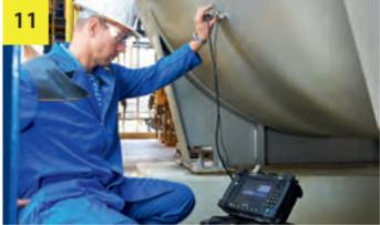
11 Mit Ultraschall Verfügbarkeit erhöhen: Wie sich mit der Phased-Array-Technologie Korrosion aufspüren lässt.
