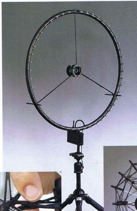
Ring 48-75 DIF, en 75-centimeters kolfiberring med 48 mikrofoner, för inom- eller utomhusbruk på relativt korta avstånd. Antal mikrofoner: 48 Mätavstånd: 0,5 - 10 m Mätfrekvens: 300 Hz - 20 kHz Dynamiskt område: 35 - 130 dB Diameter: 75 cm
