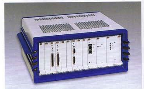
mcdRec 721, datainsamlingsenhet och A/D-omvandlare för mikrofonerna och andra sensorer. Upp till 144 mikrofonkanaler (sampling 48 - 192 KS/s). Upplösning: 24 bitar. Inspelningsbuffert vid 192 KS/s: 43 sek. 12 digitala inkanaler (sampling upp till 6,1 MS/s). 1 Gbps Ethernet mot pc Dessutom behövs programvaran Noise-Image för visning och efterbehandling i pc.
