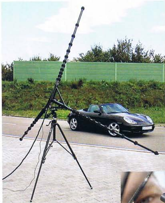
Star 36, 3-meters hopfällbar stjärnstruktur med 36 mikrofoner, för utomhusbruk på längre avstånd, för industrier, fordonsljud m.m. Antal mikrofoner: 36 Mätavstånd: 3 - 300 m Mätfrekvens: 100 Hz - 7 kHz Dynamiskt område: 35 - 130 dB Diameter: 3,4 m
