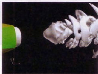
Simulation des instabilités d'un jet supersonique en sortie d'un turboréacteur. (Onera)
