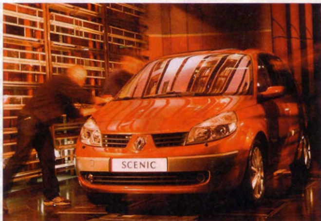
Cette soufflerie peut simuler un vent jusqu'à 240 km/h. Les bruits générés par l'écoulement de l'air sont étudiés tant pour les passagers que pour l'extérieur.
