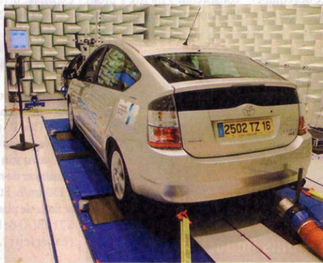
Au Cetram d'Angoulême, ce banc à quatre rouleaux permet aux équipementiers d'adapter les trains avant et arrière en fonction de différentes granulosités.
